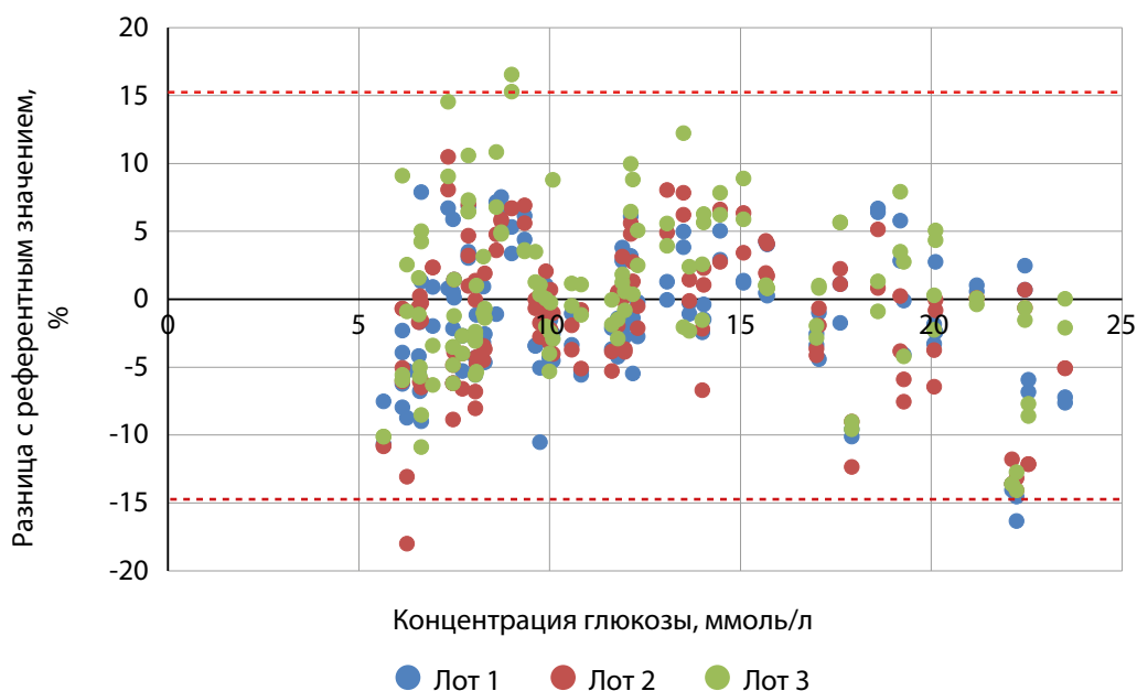
Рисунок 3. Точность системы Джимейт ЛАЙФ для образцов крови с концентрацией глюкозы выше 5,55 ммоль/л.
